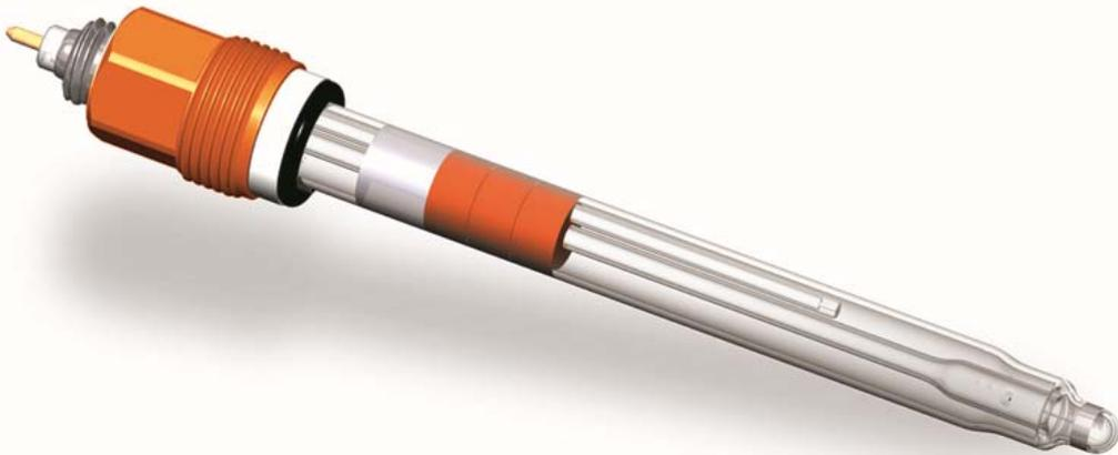
试反应介质的 ORP 值，该电极的最大特点是耐高温，因此特别选用于经常要高温蒸汽灭菌的场合。跟其它电极相比，F-995 电极的恢复时间可减少一半，反应快速，且牢固耐用，寿命长一倍。该电极通过电极护套固定安装到反应罐的侧面上。
