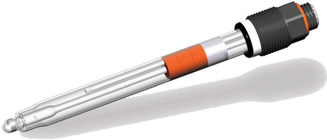
试反应介质的 ORP 值，该电极的最大特点是耐高温，因此特别选用于经常要高温蒸汽灭菌的场合。跟其它电极相比，F-935 电极的恢复时间可减少一半，反应快速，且牢固耐用，寿命长一倍。该电极通过电极护套固定安装到反应罐的侧面上。
