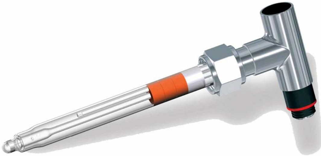
测试反应介质的 ORP 值，该电极的最大特点是耐高温，因此特别选用于经常要高温蒸汽灭菌的场合。跟其它电极相比，F-915 电极的恢复时间可减少一半，反应快速，且牢固耐用，寿命长一倍。该电极通过电极护套固定安装到反应罐的侧面上。
